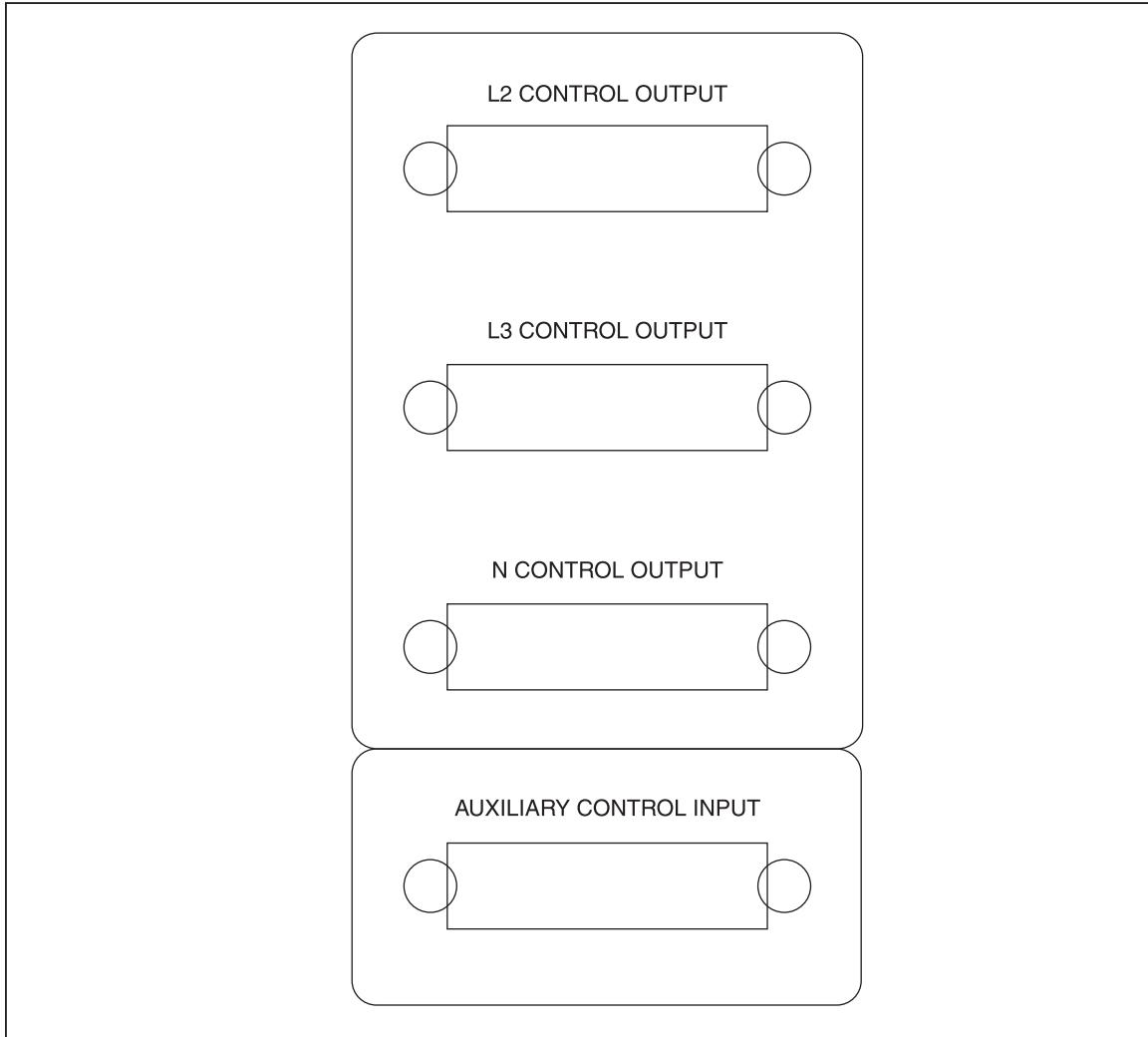
**Рис. 2-1. Разъемы вспомогательных устройств на задней панели 6105А**
