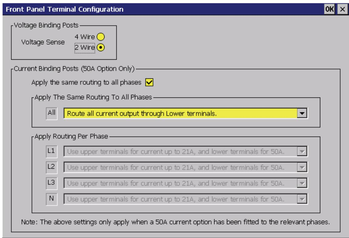
Рис. 4-6. Front-Panel Terminal Configuration (Конфигурация клемм передней панели)
