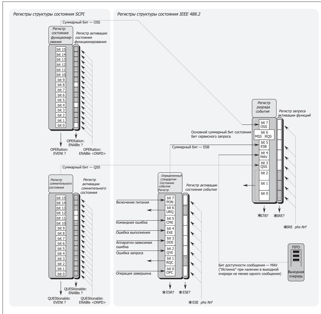
Рис. 5-2. Определенные стандартом функции IEEE 488 и SCPI
