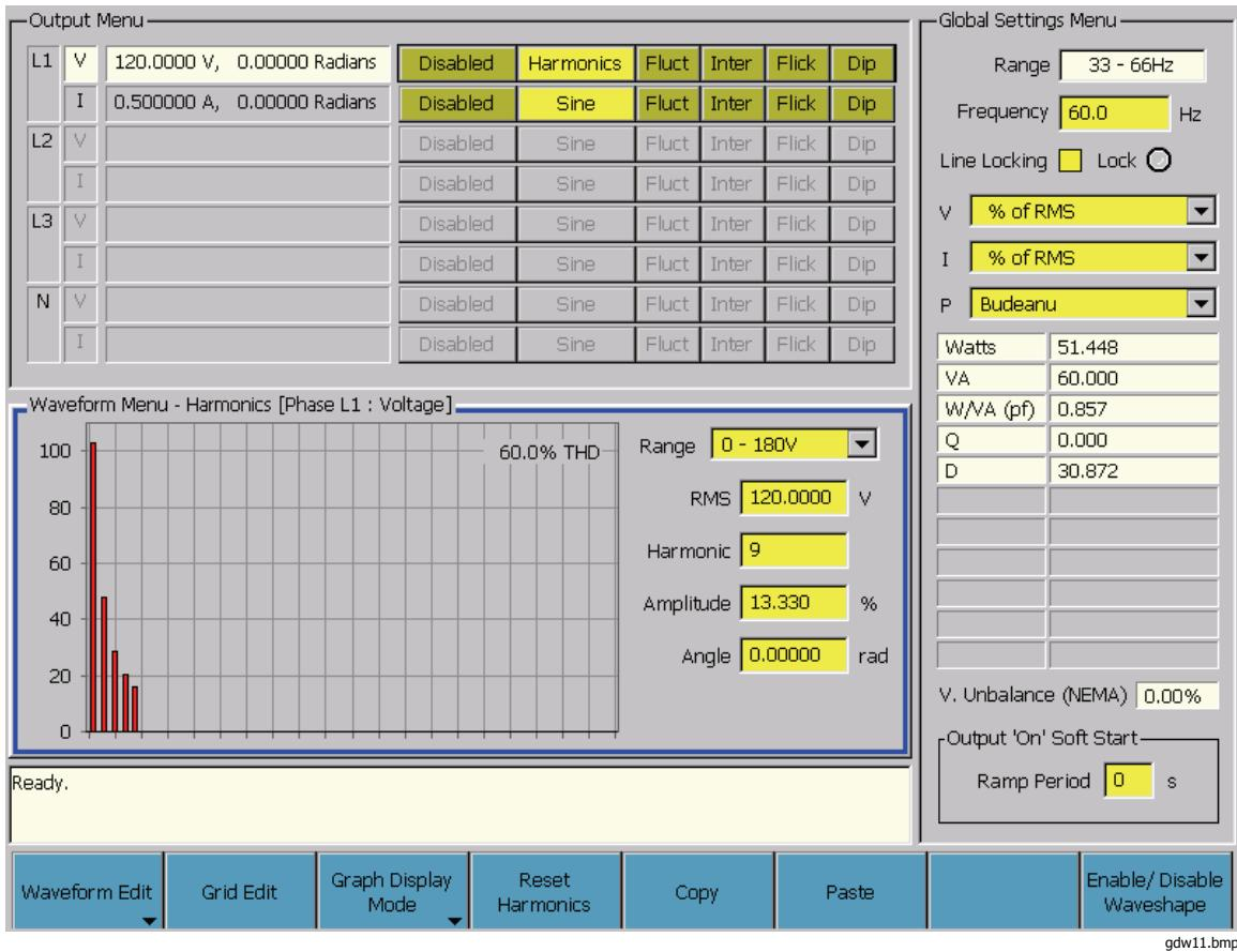
Рис. 4-13. Режим гармоник с частотным спектром сигнала
