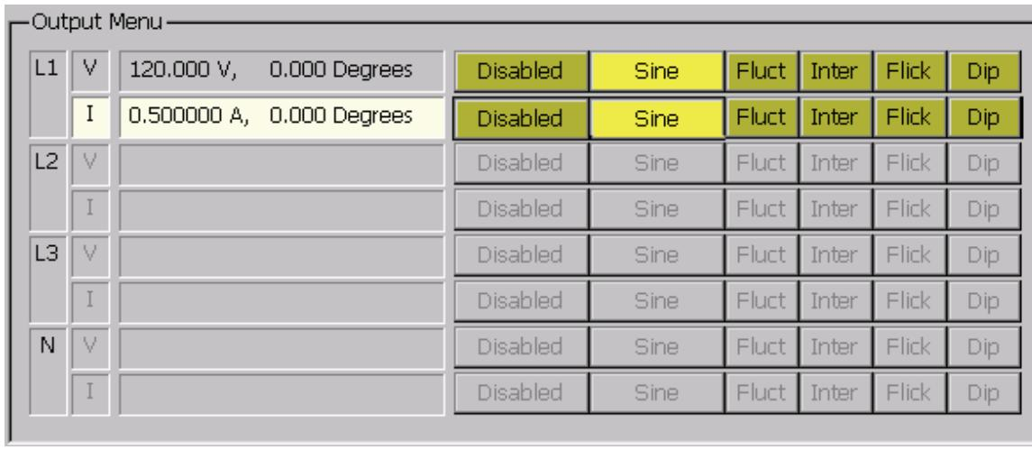
Рис. 3-4. Меню выхода Output Menu (Выбран канал тока L1)
